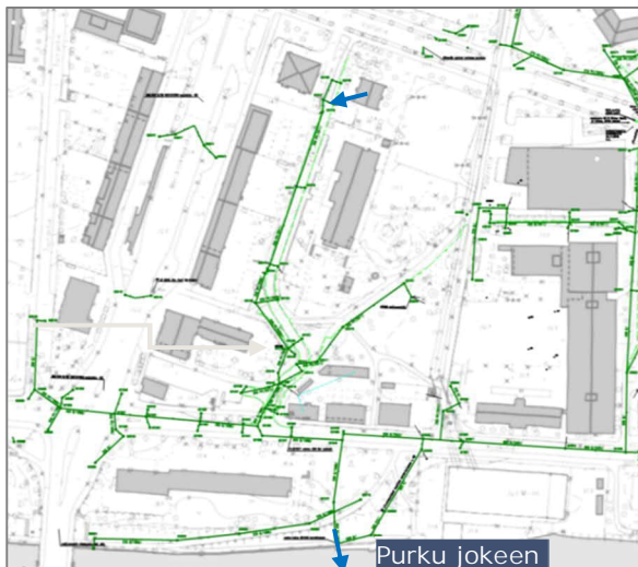
Kuva 3. Selvitysalueella sijaitseva hulevesiverkosto. (Oulun kaupunki)
